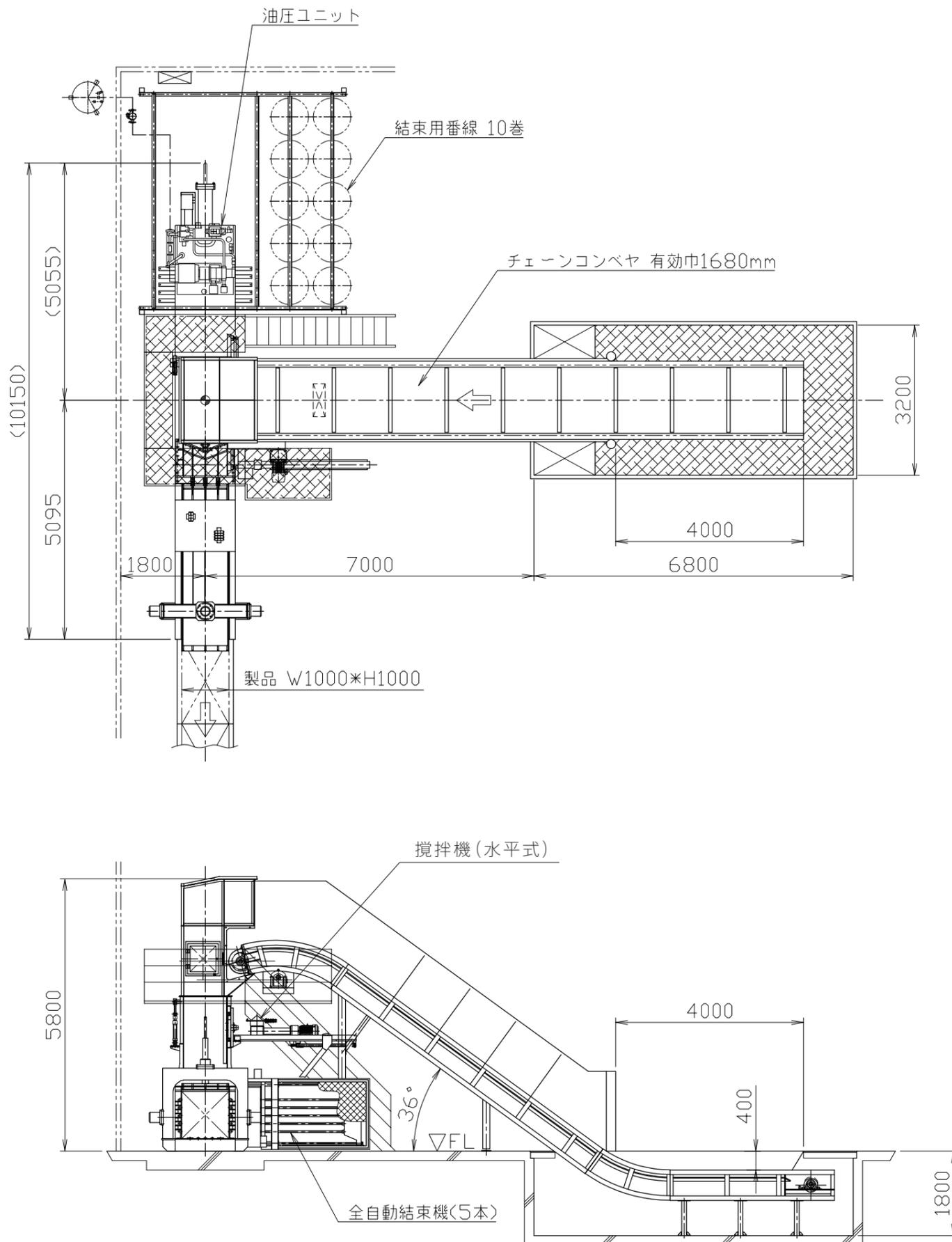
■ SW770型(D) 100HP (投入口寸法:W1000×H1100×L1650)
