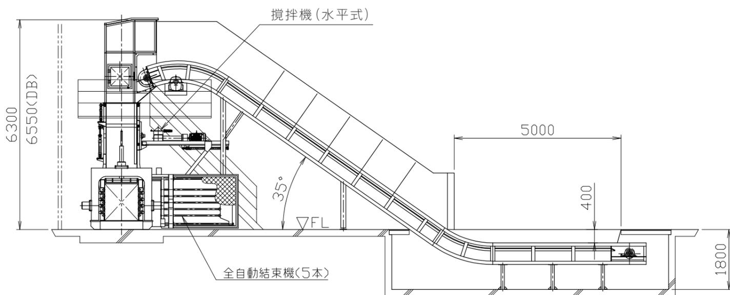
■ SW770型(D) 150HP (投入口寸法:W1000×H1100×L1650)
